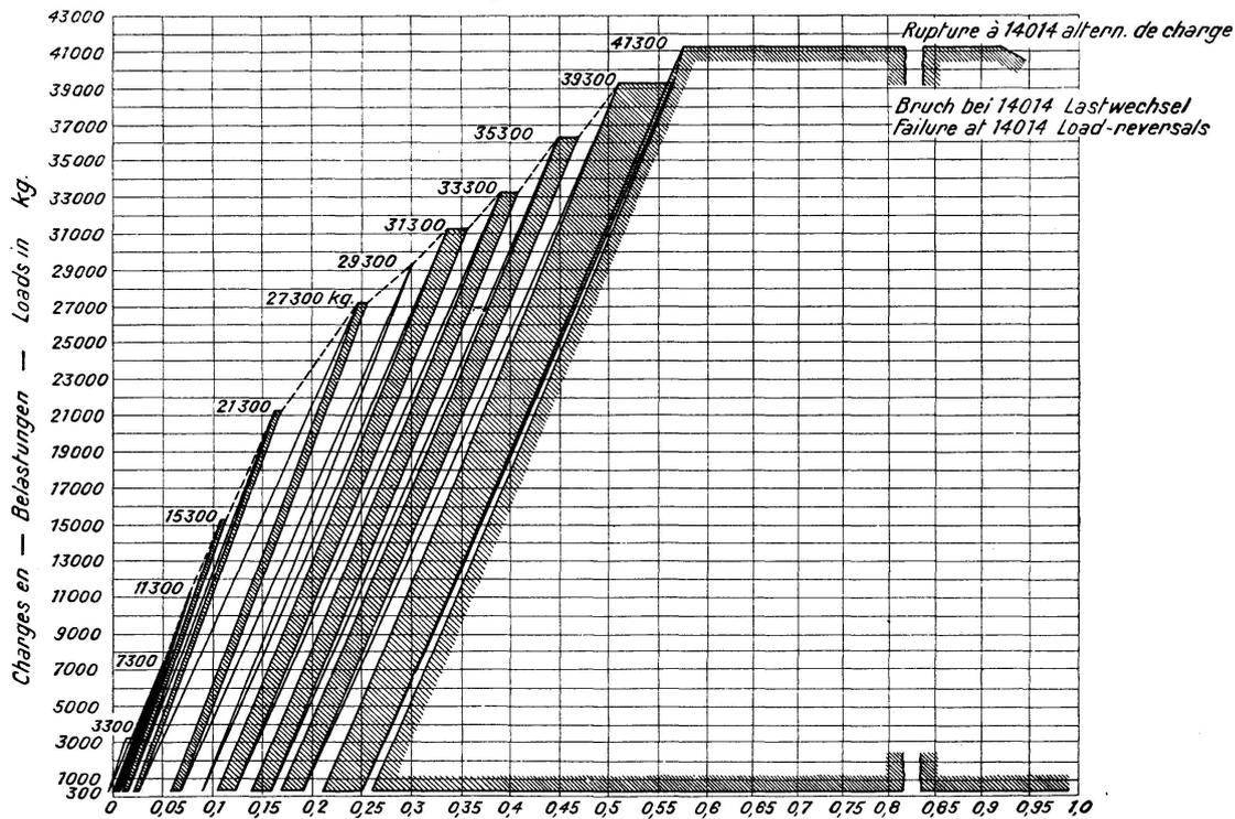
Allongements totaux en mm des intervalles de mesure A et B (valeurs moyennes). Intervalle de mesure 430 mm.
