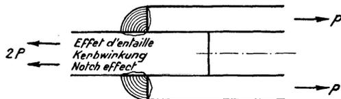
Assemblage de barreaux avec soudures frontales d'angle.
