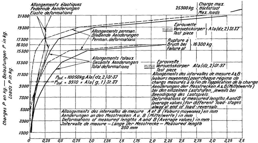
Comparison of the total and permanent deformations for static and fatigue tests. *Gegenüberstellung der beim statischen u. beim Dauerversuch gemess. gesamten u. bleib. Längenänderungen.*
