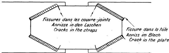
*Amorces de rupture à la fatigue dans des cordons de soudure en biais.*
