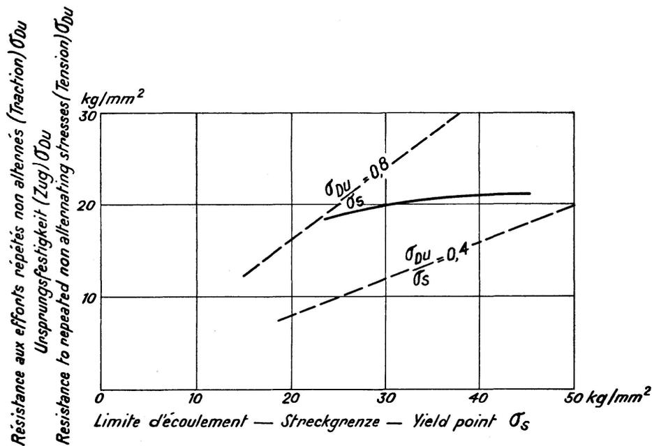
*Résistance aux efforts répétés non alternés (Traction) en fonction de la limite d'écoulement.*
