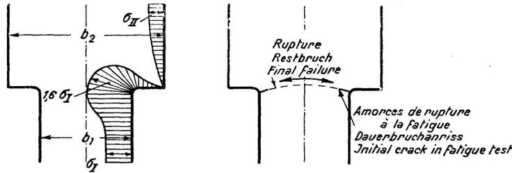
Assemblage avec modification brusque de section
