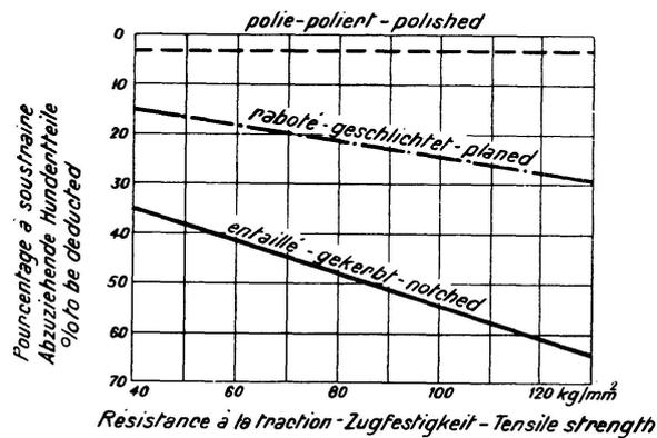
*Réduction de la résistance aux efforts répétés alternés pour différents usinages en fonction de la résistance à la traction (essai statique) d'après Fr. P. Fischer, Essen.*
