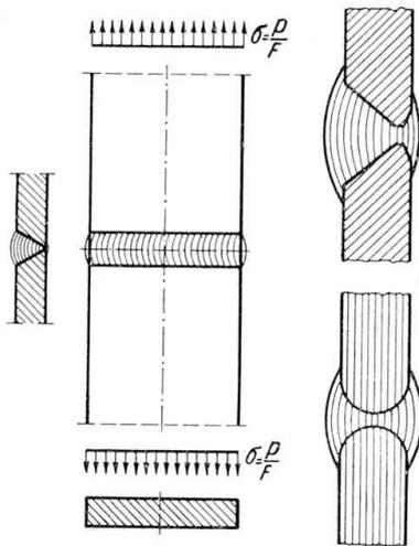
*Assemblage bout à bout sur barreaux plats de même épaisseur, avec cordons en V et X. Stumpfstoß gleich dicker Bleche mit V- u. X-Naht. Butt-weld of straps of equal thickness, with V- & X-seam.*
