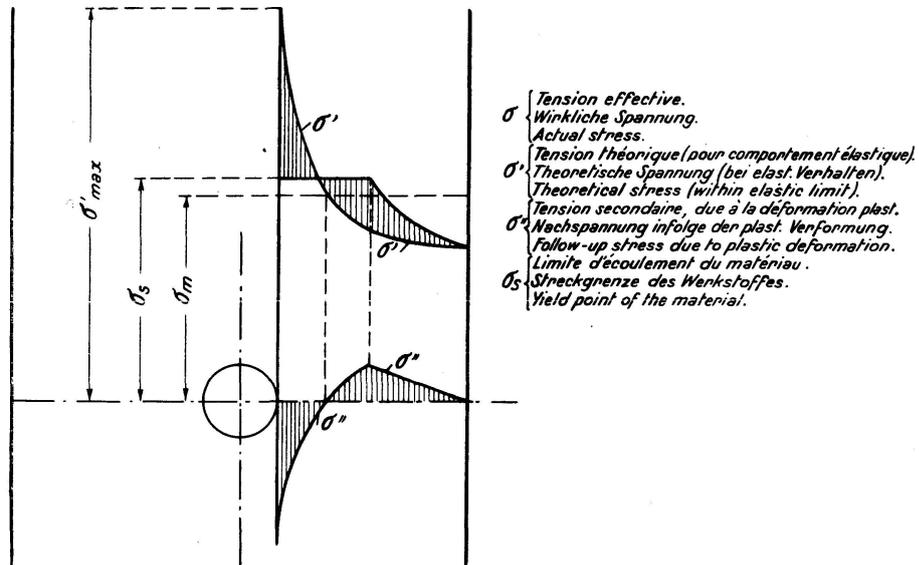
*Egalisation des tensions dans le barreau plat perforé par déformation plastique du bord de trou.
