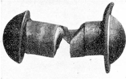
Rivet de 20 mm, prelevé sur un assemblage (barreaux de 16 mm, couvre joints de 10 mm d'épaisseur) après 100 000 alternances entre  $\tau = 0,5$  et  $20 \text{ kg/mm}^2$ .
