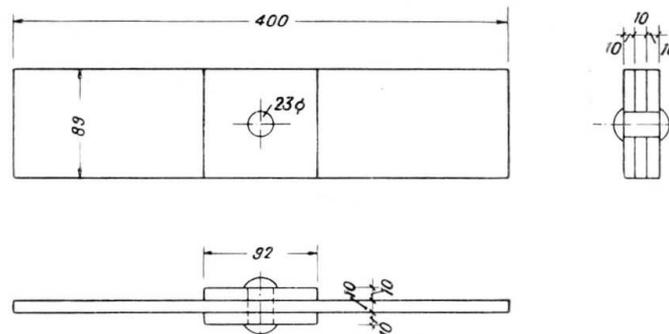
*Eprouvette avec couvre-joints rivés*
