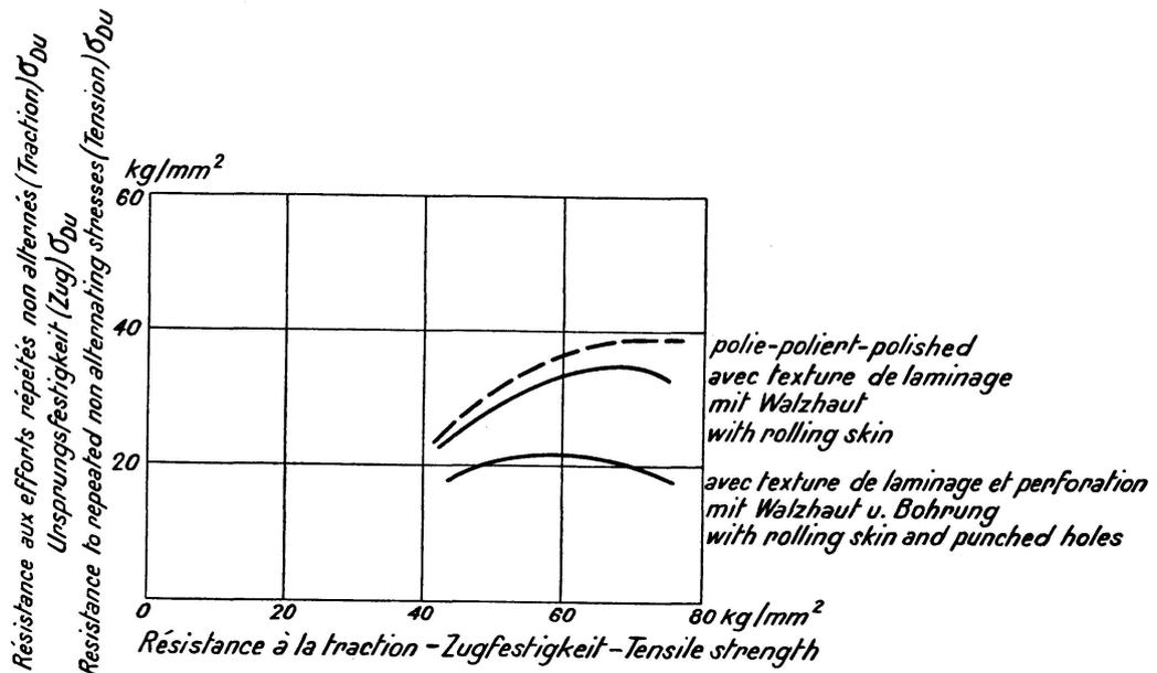
*Résistance aux efforts répétés de barres d'essai polies, avec texture superficielle du laminage, avec texture de laminage et perforation, en fonction de la résistance à la traction.*
