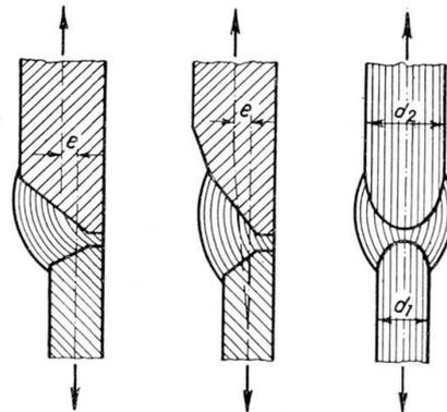
*Assemblages bout à bout sur barreaux d'épaisseurs différentes. Stumpfstoß von Blechen verschiedener Dicke. Butt-weld of flats of unequal thickness.*
