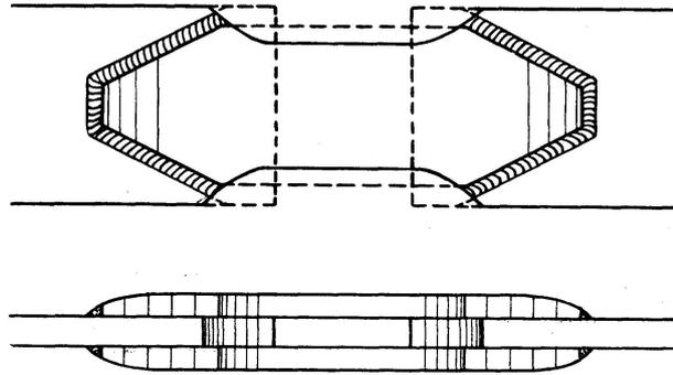
*Assemblages à couvre-joints avec cordons de soudures en biais longs et cordons de soudures frontaux courts retouchés pour obtenir une grande résistance à la fatigue.*
