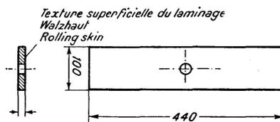
*Barreau plat perforé pour essais de fatigue à la traction.*
