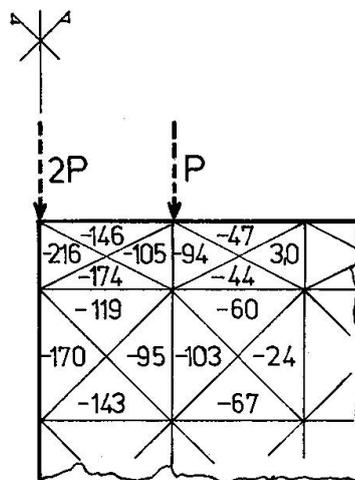
Abb. 7. Spannungen  $\sigma_x$  [kp/cm<sup>2</sup>] bei  $V = 44 \text{ Mp}$ .
