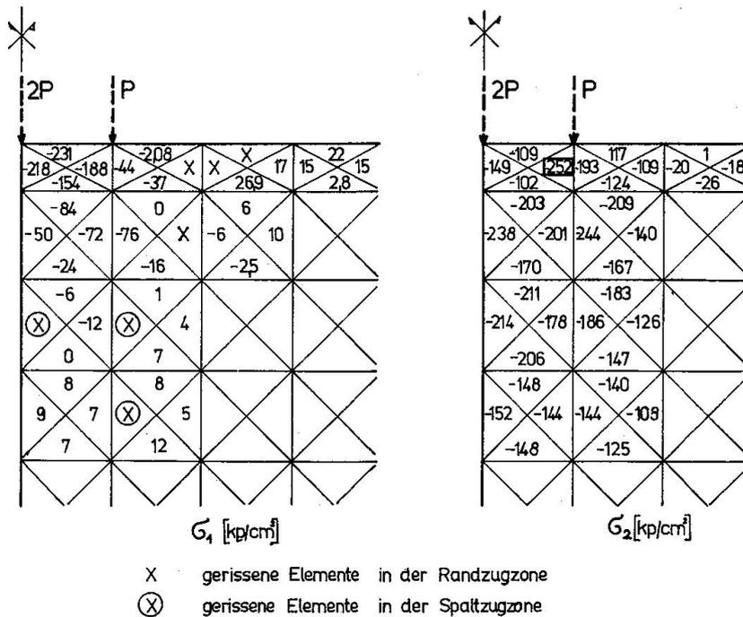
Abb. 9. Hauptspannungen bei  $V = 80 \text{ Mp}$ .
