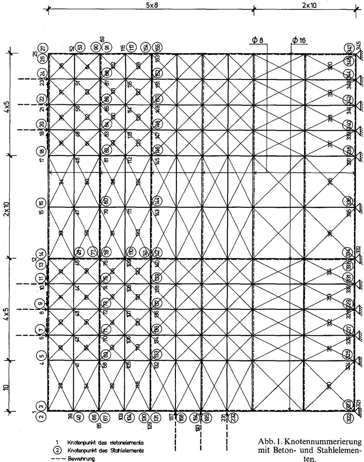
Abb. 1. Knotennummerierung mit Beton- und Stahlelementen.
