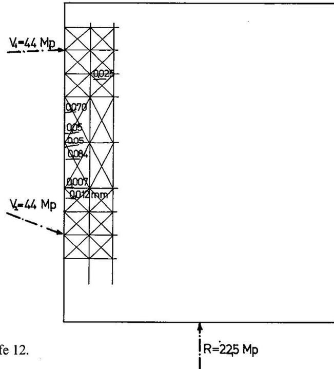
Abb. 13. Rissbreiten bei Laststufe 12.
