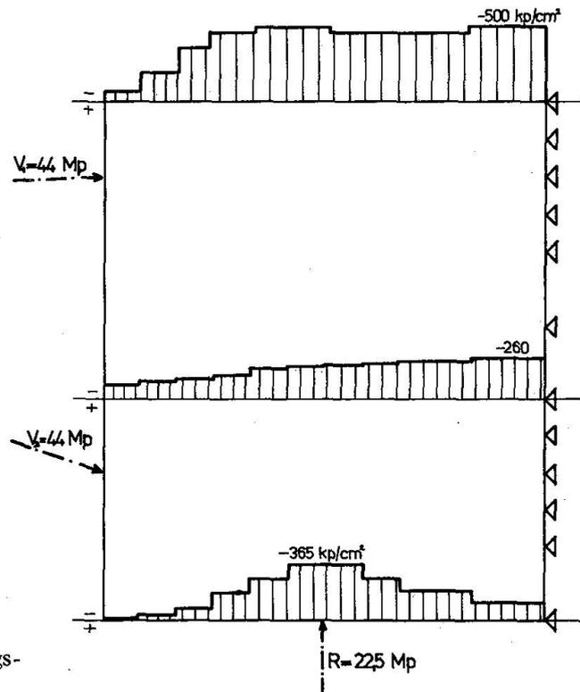
Abb. 15. Spannungen in der Längsbewehrung bei Laststufe 12.
