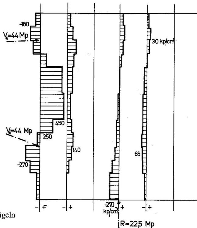
Abb. 14. Spannungen in den Bügeln bei Laststufe 12.
