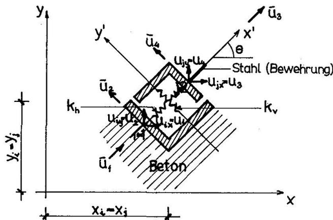
Abb. 4. Federelement.
