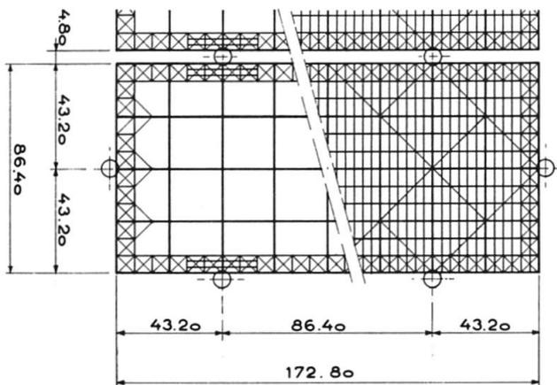
Fig. 3 Vue en plan de la charpente
