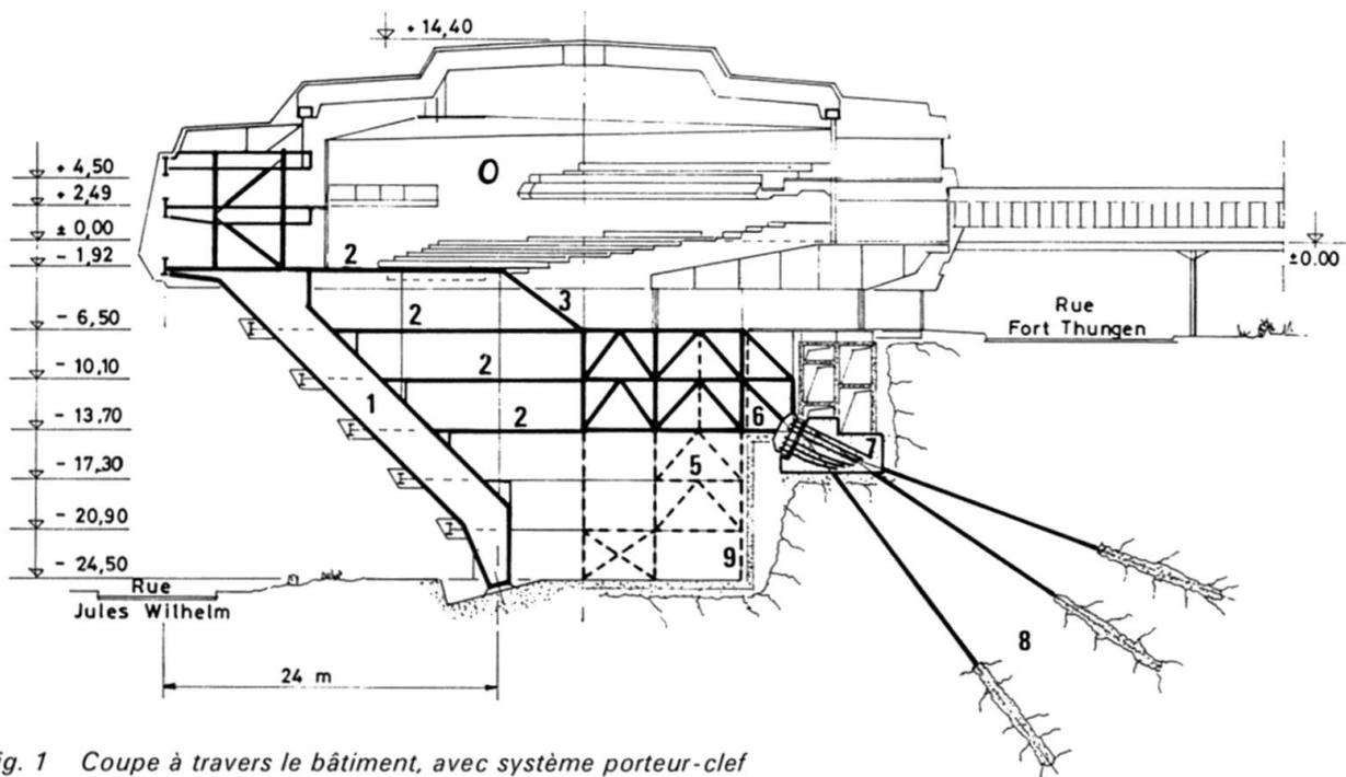
Fig. 1 Coupe à travers le bâtiment, avec système porteur-clef
