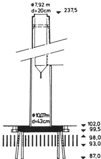
Die schluffigen Tonschichten sind wenig steif, kaum vorbelastet und veränderlich dick. Unter Bauwerkslasten waren beträchtliche Setzungen und unkontrollierbare Setzungsunterschiede zu erwarten. Sie wurden durch Sandaufschüttungen vorweggenommen, nach 100 Tagen Vorbelastung wurden Setzungen bis zu 100 cm gemessen.
