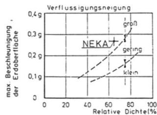
BODENVERFLÜSSIGUNG: max. Beschleunigung der Erdoberfläche der wassergesättigten Feinsande
