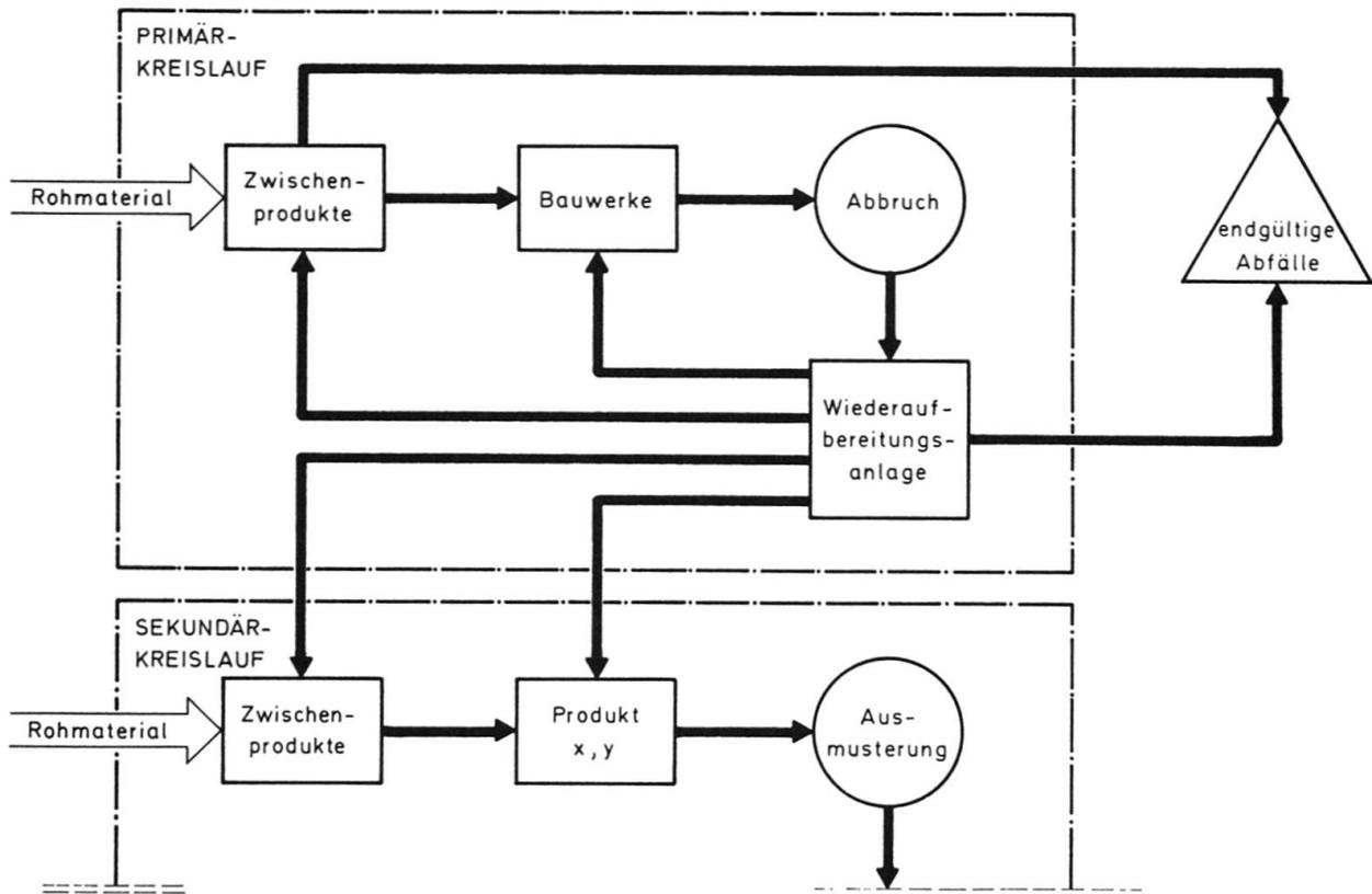
Bild 7 Schema eines Recycling-Kreislaufs für Bauschutt nach [8]
