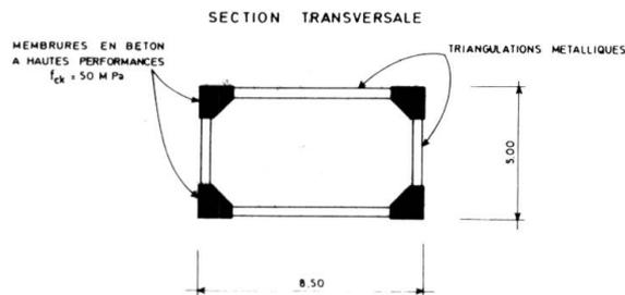
Fig. 23 - Arc triangulé en béton à hautes performances
