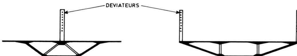
Fig. 29 - Précontrainte extradossée - Structures transversales
