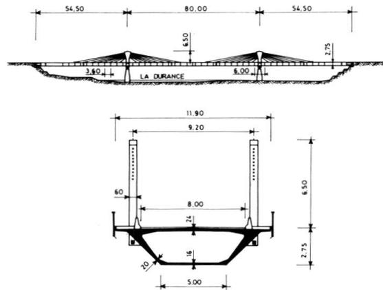
Fig. 34 - Pont de Mirabeau - Projet SECOA pour la D.D.E. des Bouches du Rhône
