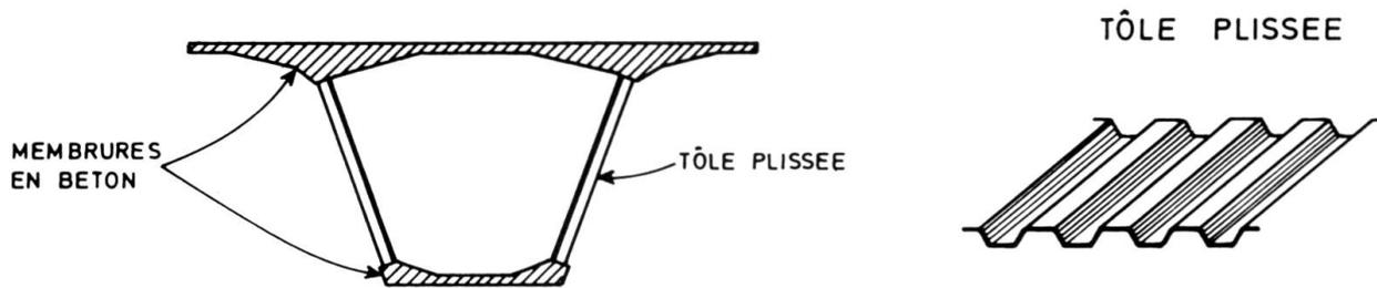
Fig. 6 - Ames métalliques en tôle plissée
