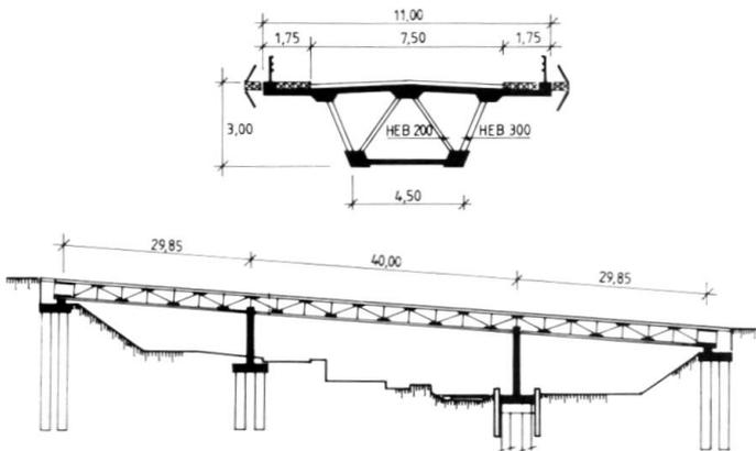
Fig. 10 - Pont d'Arbois - Coupes longitudinale & transversale
