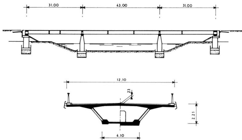
Fig. 7 - Pont de Cognac - Coupes longitudinale & transversale
