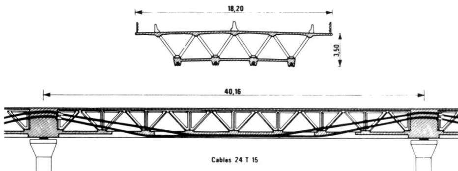
Fig. 14 - Schéma de câblage et coupe transversale du Pont de Bubiyan
