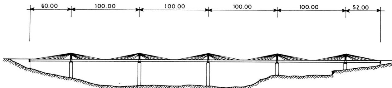
Fig. 30 - Viaduc de l'Arrêt Darré - Coupe longitudinale
