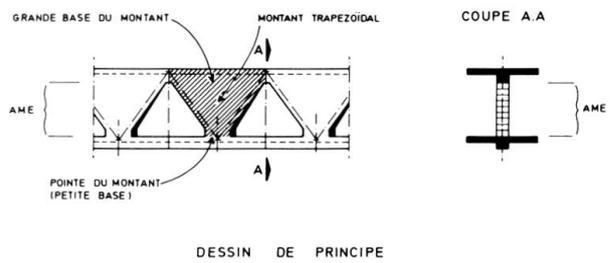
Fig. 17 - Ames évidées à montants trapézoïdaux
