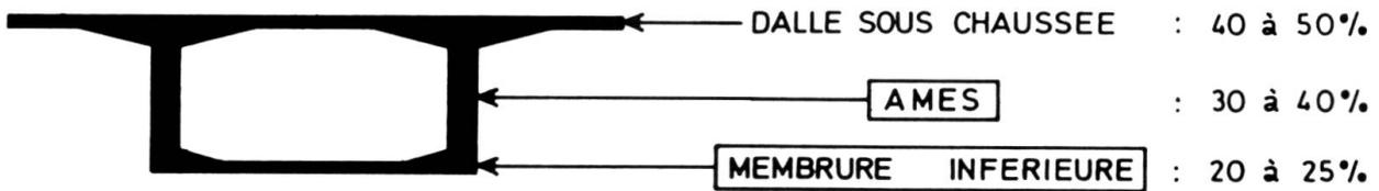
Fig. 1 - Poids relatif des éléments de la structure transversale
