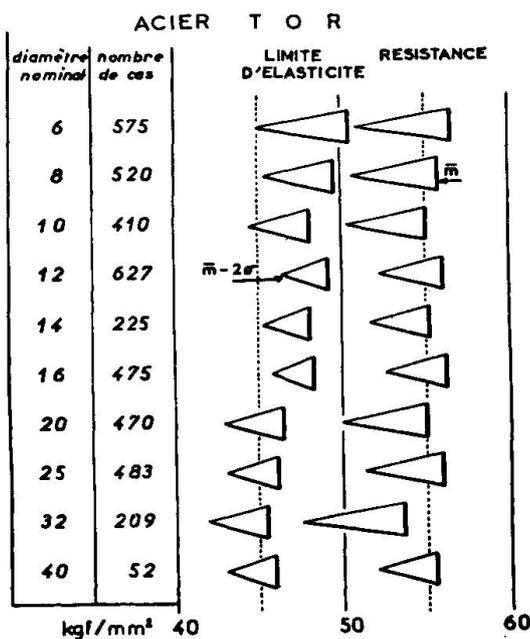
Il s'agit ici d'acier Tor, les petits diamètres  $\phi \leq 10$  comportent des nervures, les diamètres supérieurs des nervures et verrous
