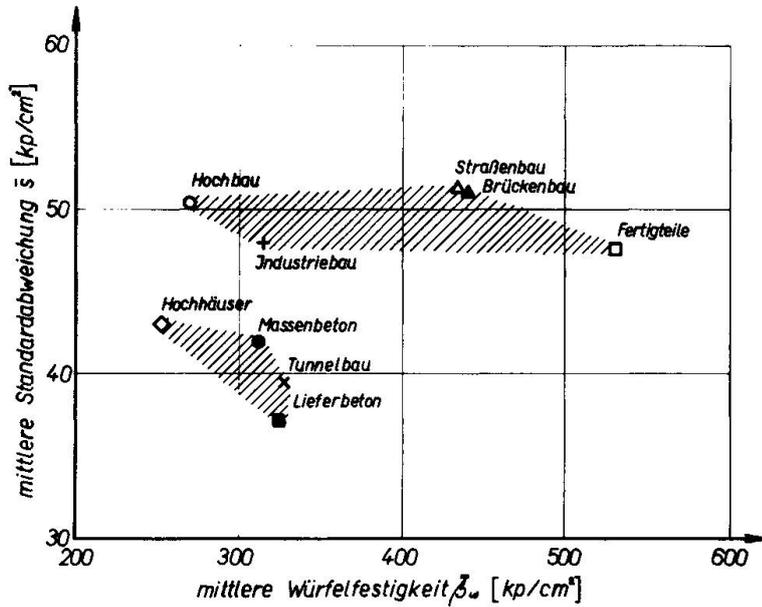
Bild 2: Mittlerer Einfluß der Art der Baustelle auf die Standardabweichung und Betonfestigkeit
