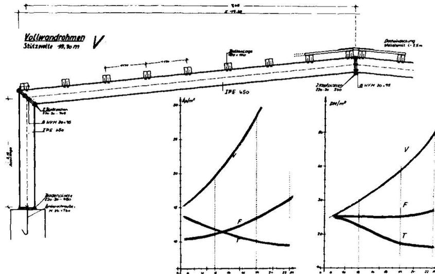
Bild 1: Rahmenbinder aus hohen Walzprofilen ohne Materialausnutzung über die gesamte Länge
