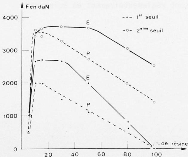
Fig. 2 Variation des résistances aux seuils de glissement en fonction du dosage en résine
