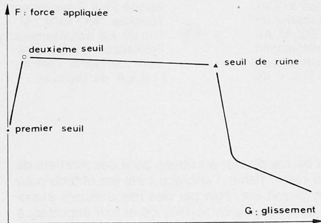
Des capteurs de déplacements, montés sur l'éprouvette permettent de tracer, en continu, les courbes représentatives du glissement de l'extrémité non chargée de la barre, par rapport au béton.
