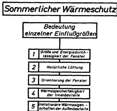
Bild 4 Bedeutung der einzelnen Einflußgrößen für den sommerlichen Wärmeschutz einer Fassade. Die Nummerierung stellt keine Aufzählung, sondern eine Rangfolge für die einzelnen Parameter dar.
