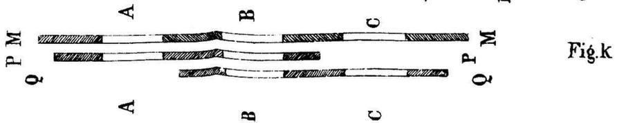
fixe Q est identique à P, seulement elle est placée plus bas, les deux ondes devant correspondre aux ondes B et C de la plaque M. A la hauteur de A et de C, il y aura donc deux ondes superposées ; à la hauteur de B (du milieu) il y aura trois ondes, provenant des trois plaques P, Q et M.
