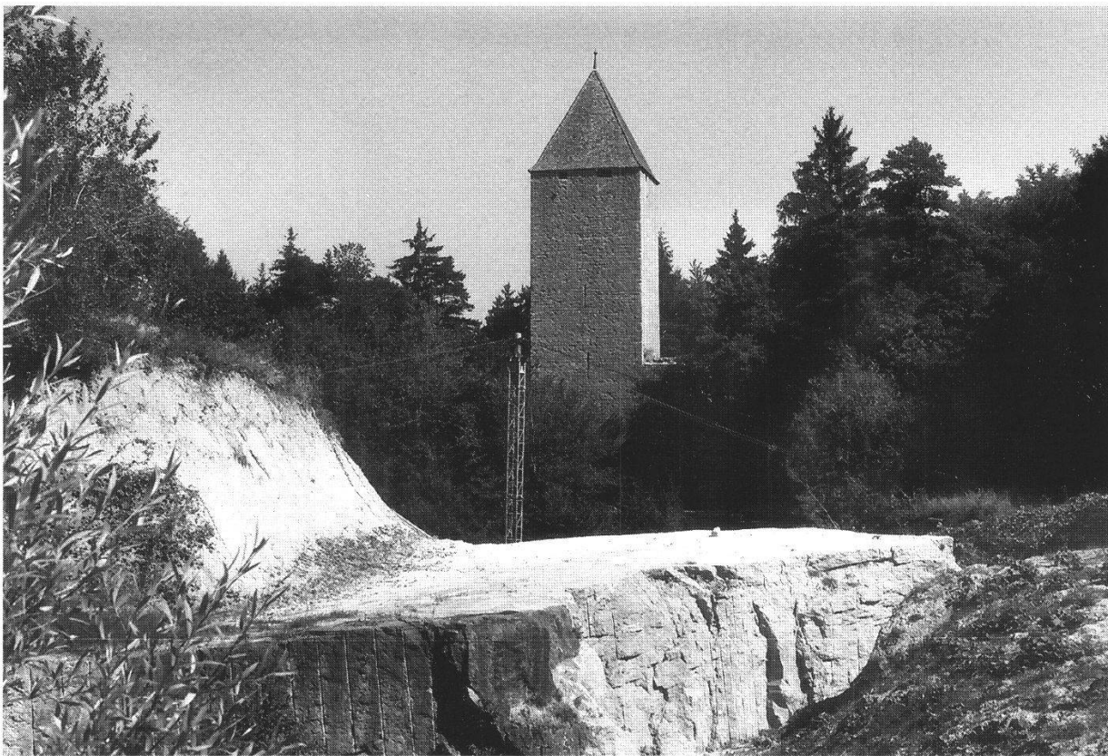
Figure 2.—La Tour de la Molière, au pied de laquelle s'ouvre la carrière actuellement en activité, dont on distingue le mât de charge derrière le banc de grès coquillier exploité et partiellement visible. La surface supérieure du banc avait été dégagée par le glacier du Rhône qui y a buriné des stries glaciaires (MORLOT 1854), avant de la recouvrir de sa moraine de fond (talus incliné à gauche). Photo M. Weidmann, septembre 1999.
