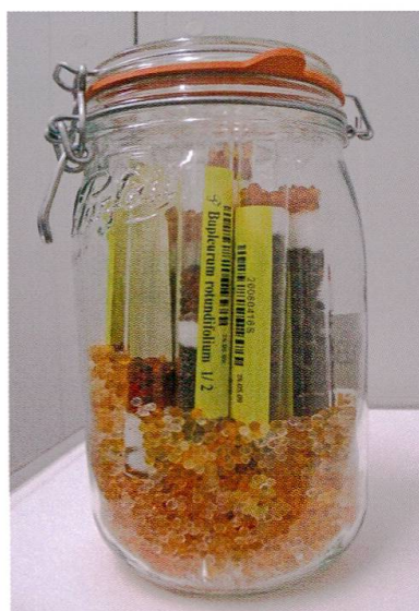
Illustration 5 : à gauche, un exemple de tubes scellés à la flamme où sont réparties les graines d'un lot. À droite, un bocal de conserve sert de deuxième enceinte étanche pour environ 18 tubes scellés posés sur un lit de silicagel.
