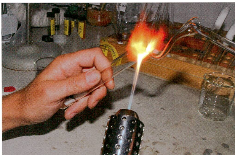
Illustration 4 : les tubes pour le stockage sont scellés à la flamme dans la chambre sèche.
