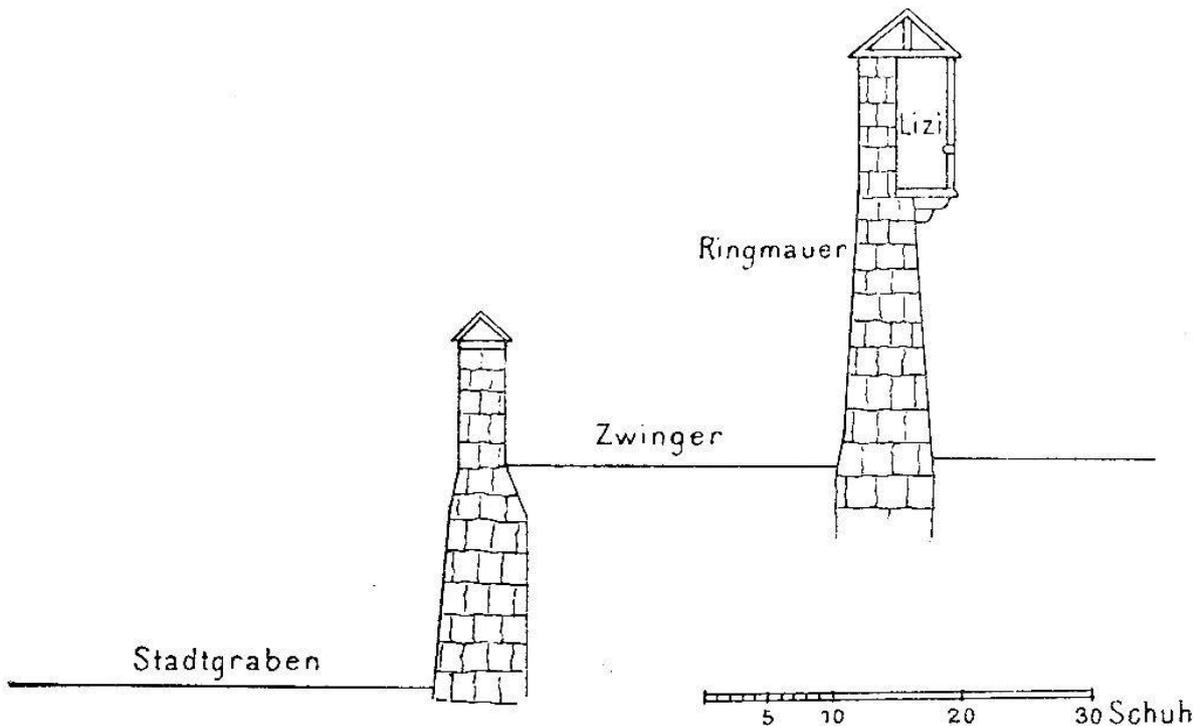
daß die Lizi beschädigt würde. In einem Plane zu diesem Projekt sind auch die beiden Ringmauern mit der Lizi angegeben. Wir entnehmen diesem Plane folgende Maße: Die Höhe der innern Ringmauer beträgt 30 Bern Schuhe, ihre Dicke 5—6'. In einer Höhe von 19' ist die Lizi (der Wehrgang) angebracht. Der Zwinger hat eine Breite von 24'; die Maße der äußern Ringmauer sind: Breite 3', Höhe 8<sup>1</sup>/<sub>2</sub>', der Stadtgraben ist 13<sup>1</sup>/<sub>2</sub>' tief und 65—70' breit.
