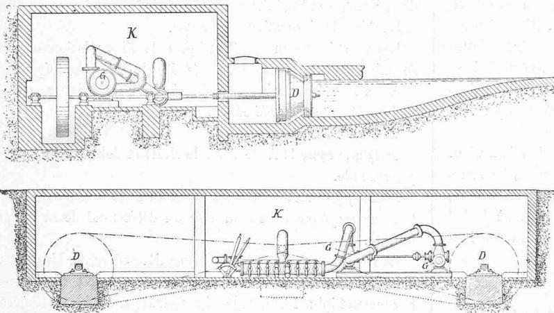
jets extérieurs chacun 15 litres et les 7 couronnes chacune 5 litres par seconde. La hauteur des jets se règle à volonté au moyen de robinets dont est muni chaque ajustage.
