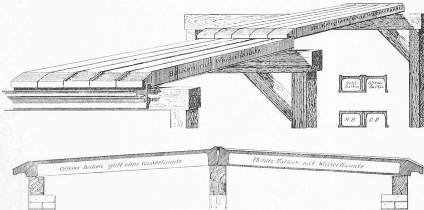
Fig. 8. — CONSTRUCTION D'UNE TOITURE EN TERRASSE
