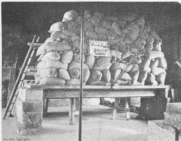
Fig. 4. — Essai de charge de la poutre N° 2.
