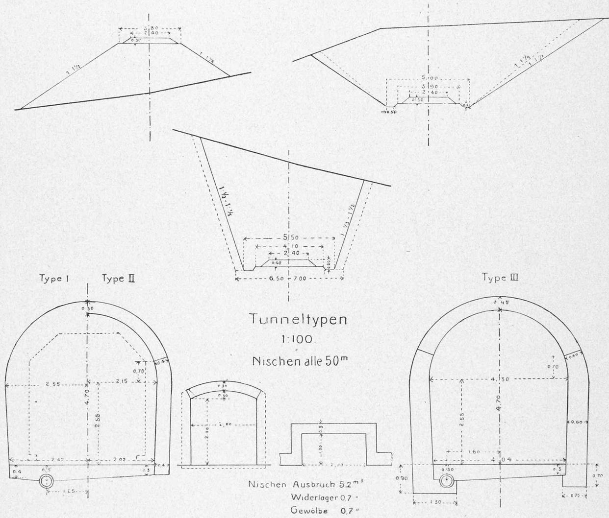
Fig. 3. — Remblai et déblai, tunnels et niches. — Echelle : 1 : 100.
