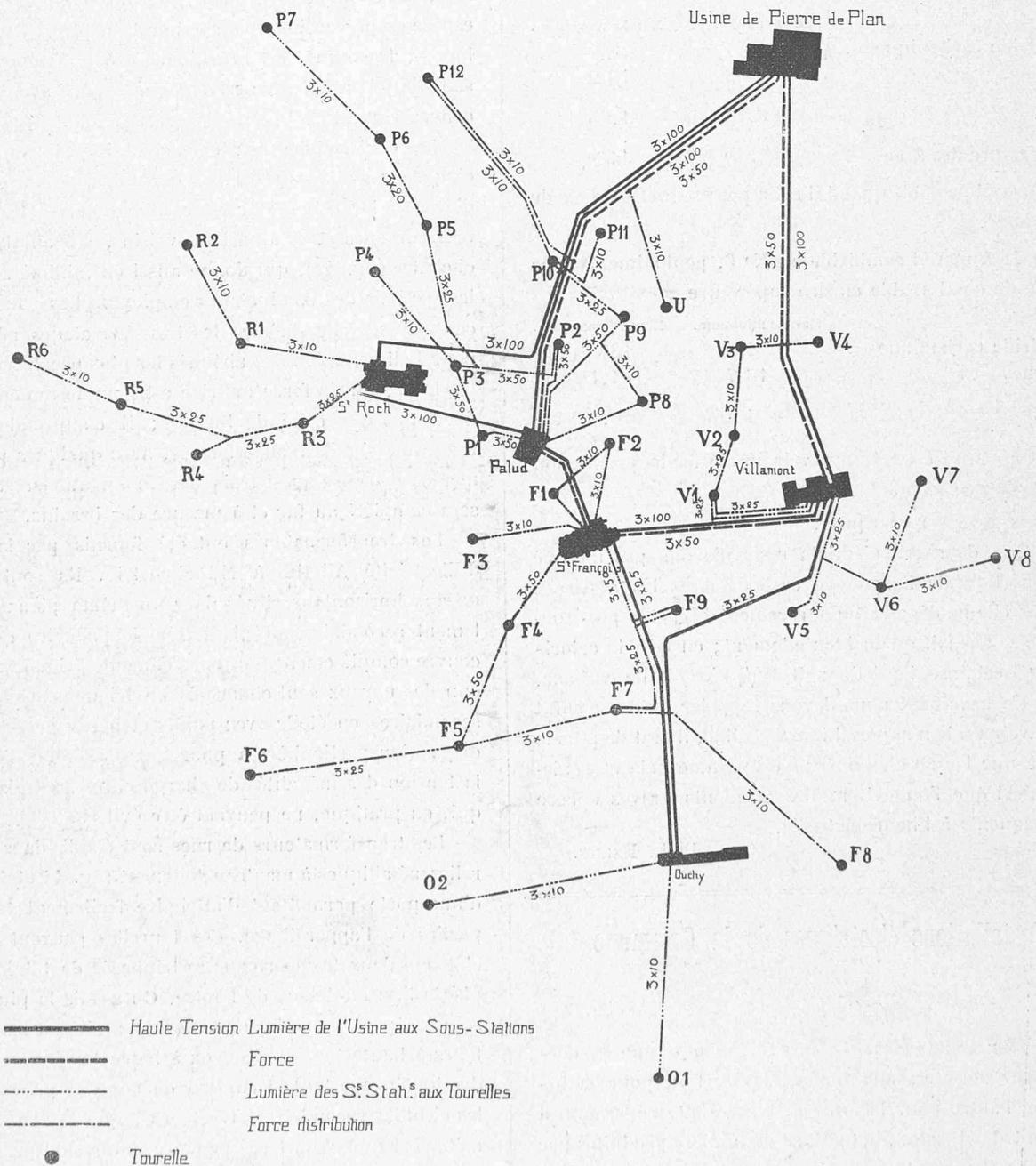
Fig. 42. — Schéma du réseau à haute tension.
