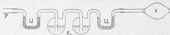
Schéma de l'appareil pour la détermination de la vapeur d'eau dans les gaz de combustion.
