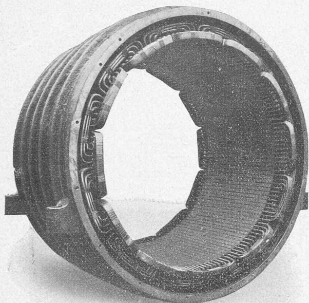
Fig. 2. — Stator d'un moteur de 450 chevaux des locomotives électriques du Simplon.
