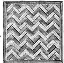
Vissé sur faux ou vieux plancher, rendu posé au bain de mortier de silicate de soude sur béton en ciment Portland, ou béton en scorie,
