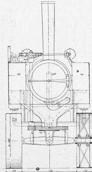
FIG. 3. — LABOUREUSE A VAPEUR (MODÈLE DE 45 CHEVAUX). — Echelle : 1 : 40.
