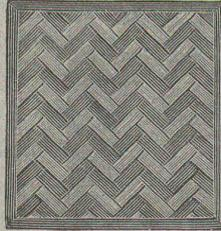
Vissé sur faux ou vieux plancher, rendu posé au bain de mortier de silicate de soude sur béton en ciment Portland, ou béton en scorie, selon tous les dessins : carré, octogones, etc., en quatre couleurs et en forme de fougères (bâtons rompus).
