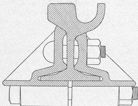
Fig. 10. — Eclisses « Atlas rail-joint ». — Echelle : 1 : 3.
