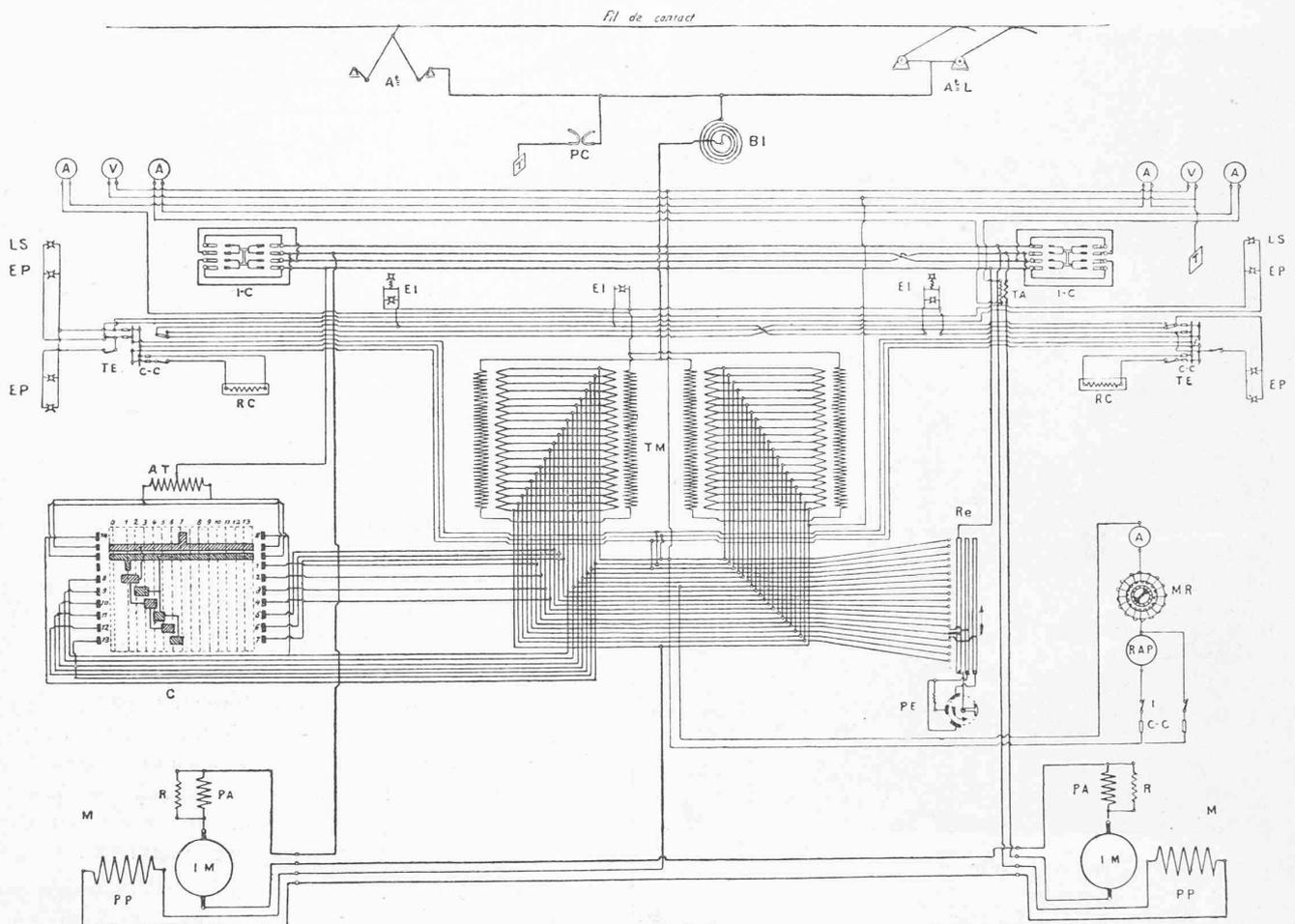
Fig. 34. — Schéma électrique de la locomotive monophasée N° 2.
