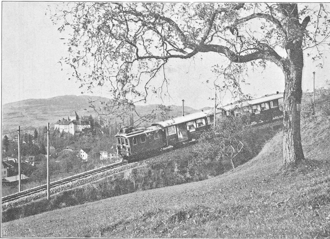
Fig. 15. — Vue d'un train sur rampe de 200 ‰.
