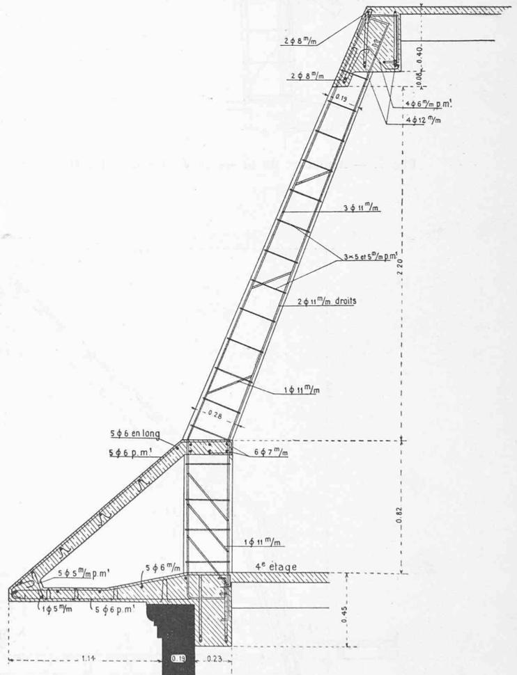
Fig. 6. — Armature du brisis au 4<sup>e</sup> étage. — Coupe. — 1 : 30.
