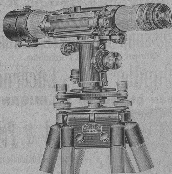
Les instruments pour des nivellements
