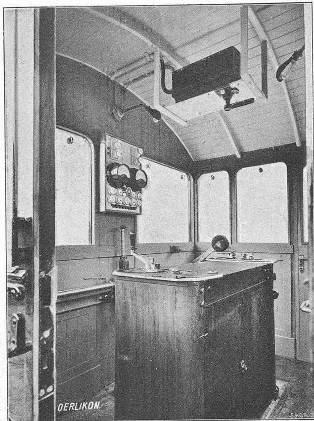
Fig. 4. — Cabine du mécanicien.
