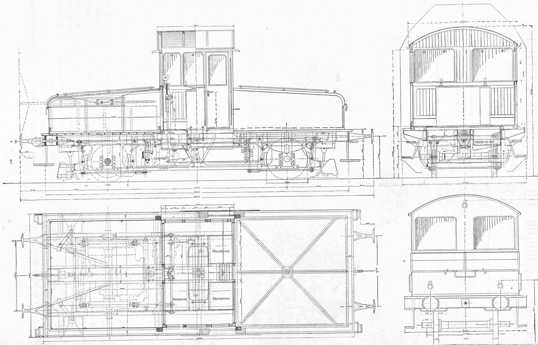
Fig. 2. — Locomotive à accumulateurs pour la construction du 11<sup>m</sup> tunnel du Simplon — 1 : 50.
