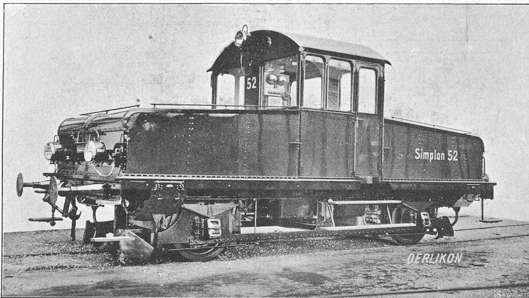
Fig. 1. — Vue de la locomotive à accumulateurs.
