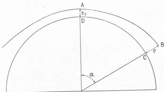
$e$  désignant l'épaisseur au joint qui fait avec la verticale l'angle  $\alpha$  et  $e_0$  étant l'épaisseur à la clef. La formule (1) exprime donc que la projection verticale de l'épaisseur en un joint de la voûte est constante et égale à l'épaisseur à la clef. Une analyse fort brève montre que la courbe d'extrados répondant à la formule (1) est une conchoïde de Nicomède, d'où découle un procédé très simple pour décrire la courbe.
