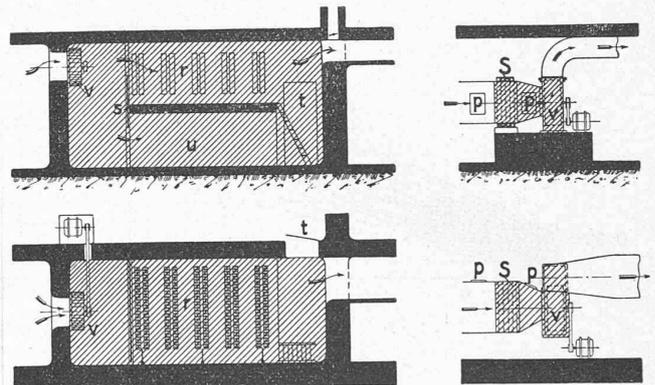
Fig. 7. — Comparaison de la place occupée par une chambre de chauffage en maçonnerie et par un appareil *Sendric* de même effet.
