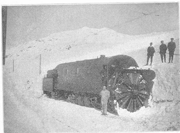
Fig. 61. — Chasse-neige faisant corps avec la locomotive.
