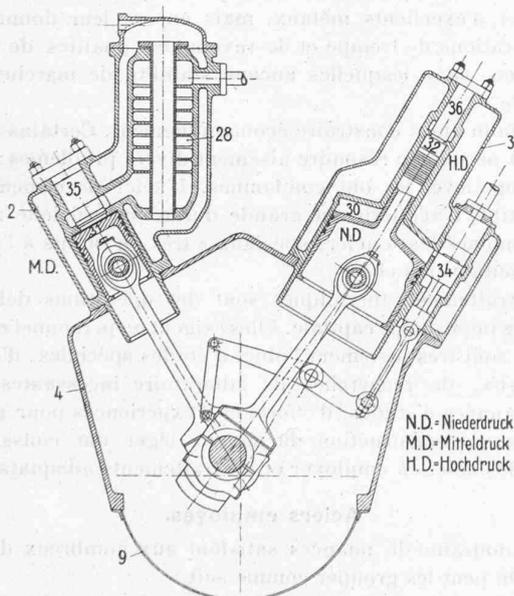
Fig. 8. — Compresseur d'air.
