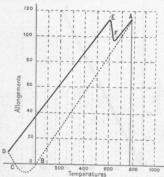
Fig. 4. — Courbe de dilatation d'un acier à 33 0/0 de nickel refroidi dans l'air liquide.
