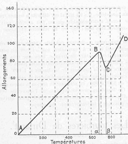
Fig. 2. — Principe général du traitement d'un acier.
