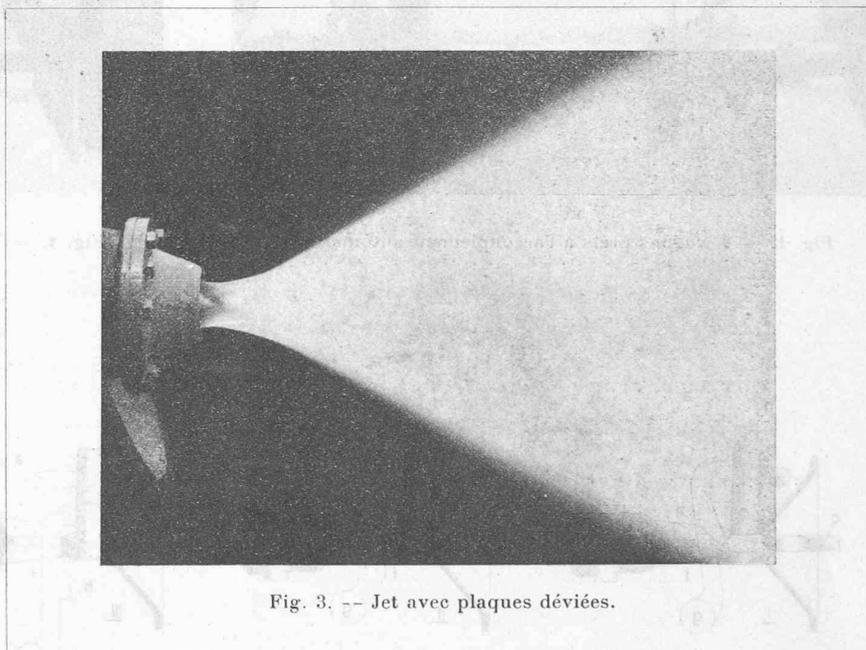
Fig. 3. -- Jet avec plaques déviées.
