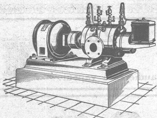
Couplage direct avec électromoteurs ou commande par courroie.
