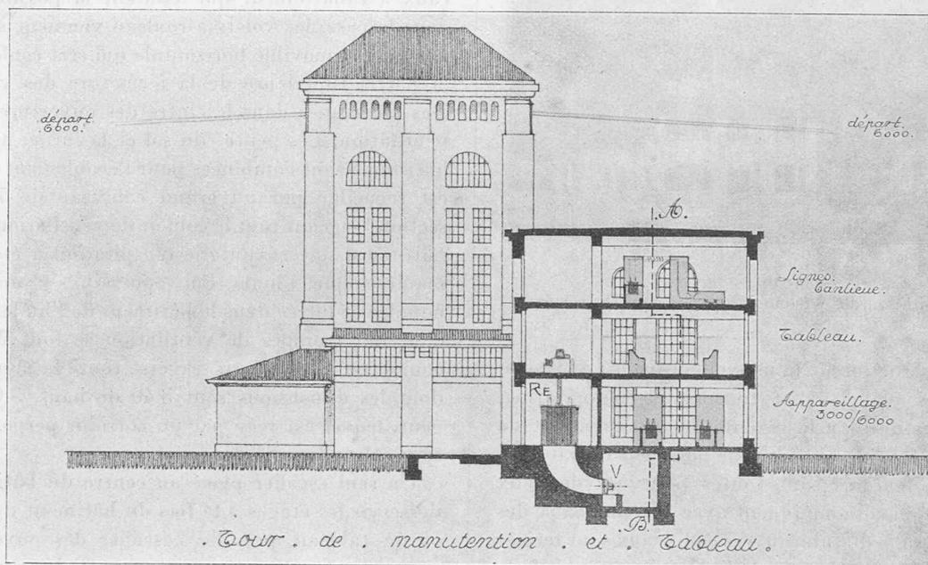
Fig. 45 — Coupe de l'usine de Pierre-de-Plan.
