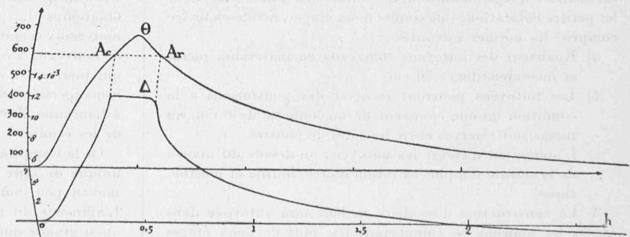
Fig. 3. — Anomalie de la dilatation du quartz.
