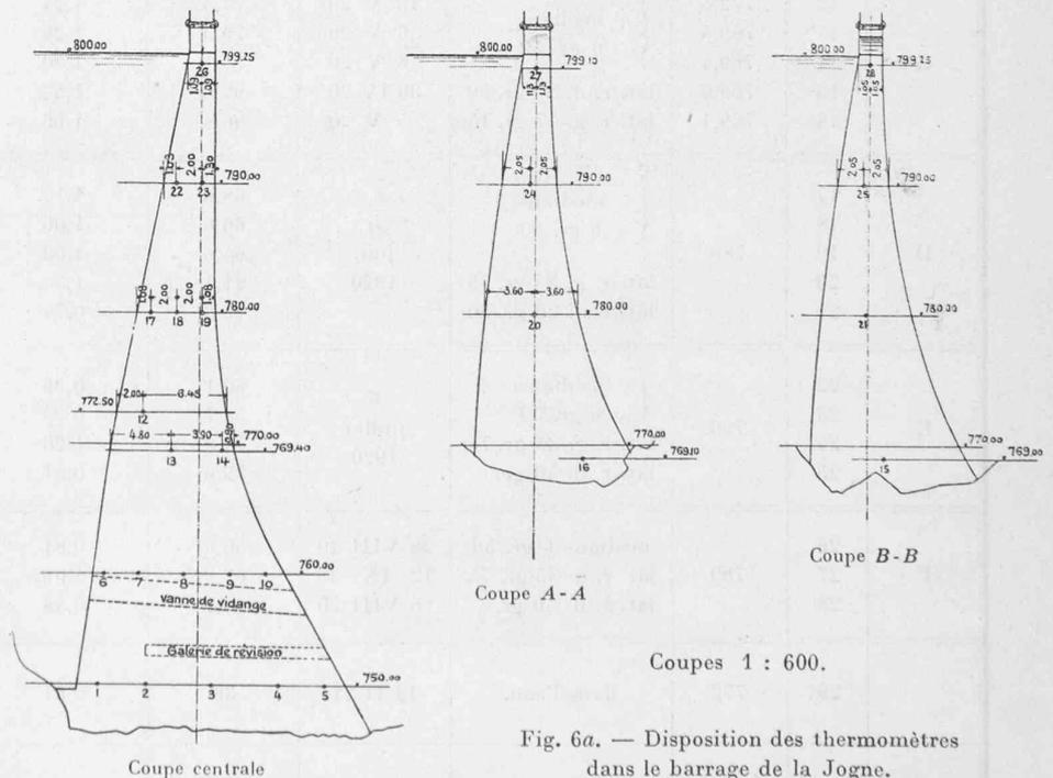
Fig. 6a. — Disposition des thermomètres dans le barrage de la Jogne.
