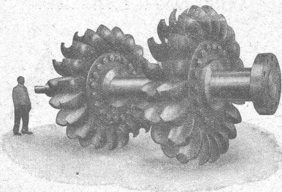
Roues motrices turbines Pelton 14300 HP.
