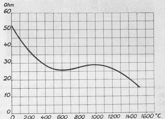
Fig. 1. — Résistance d'un corps de chauffe de quartzilite en fonction de sa température.
