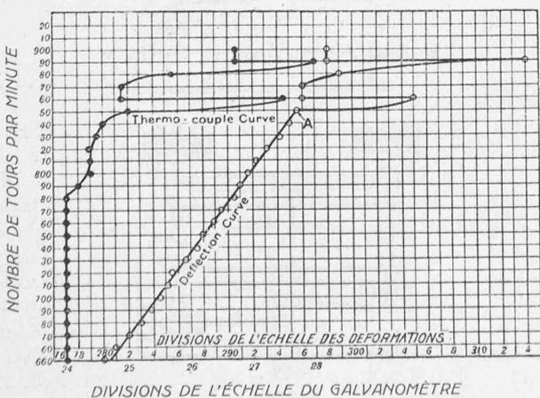
Fig. 2. — Nickel sollicité à la torsion alternative.
