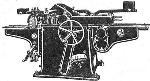
*Machine à quatre faces pour roboter
