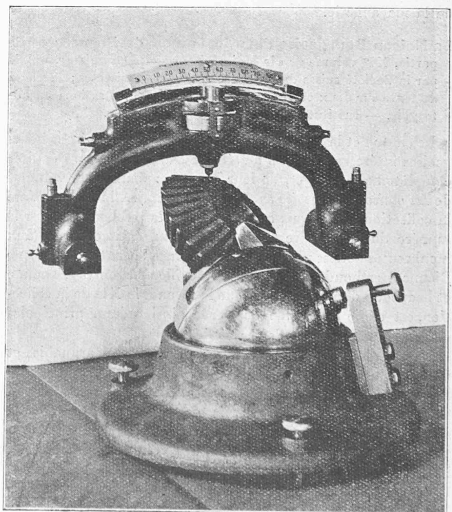
Le pendule Herbert pour la mesure de la dureté.
