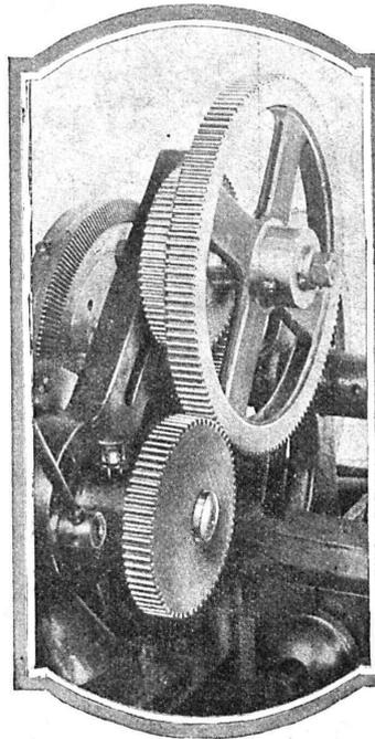
Le fonctionnement des engrenages métalliques produit un bruit énervant. L'engrenage en métal s'use rapidement ; son fonctionnement produit un gaspillage de matériel et de force.
