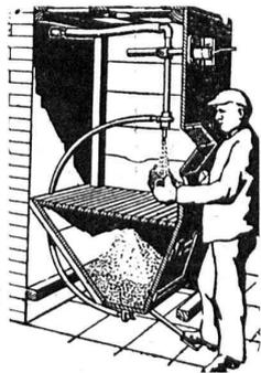
**Appareil à jet de sable**
