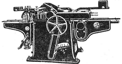
Machine à quatre faces pour roboter et moulurer Mod. D V S.
