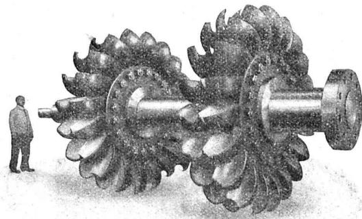
Roues motrices turbines Pelton 14300 HP.
