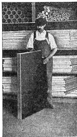
Les propriétés de la « Fibre Diamond » la rendent indispensable pour les travaux d'isolation. En plus de sa force diélectrique elle répond à tous les besoins auxquels doit pourvoir tout matériel d'isolement. Elle est extrêmement dure et résistante, sans cependant être cassante et elle ne craque pas ni ne se brise comme la porcelaine ou le caoutchouc durci.
