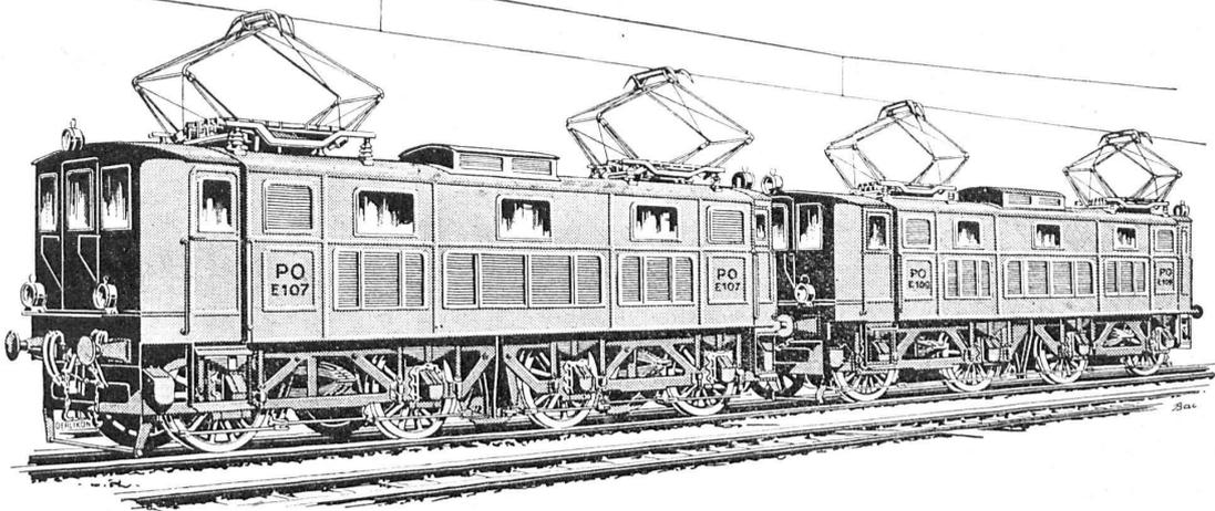
Locomotive électrique à courant continu, haute tension pour la
